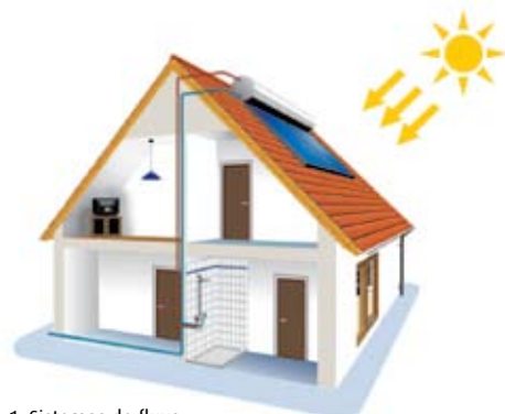
1. Sistemas de fluxo natural (terrossifão) Águas quentes Sanitárias
