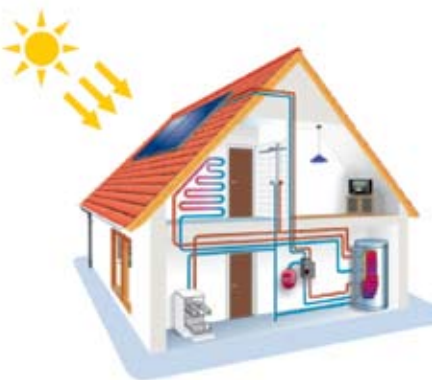
2. Sistemas de circulação forçada Solar Combi - Águas Quentes sanitárias + aquecimento
